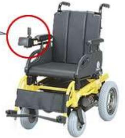
モーターで駆動する車椅子です。スティックの操作だけで自走できる自走式と介助者の負担を軽減するための介助式があります。家庭用電源で簡単に充電できますが、総重量が20キロ以上と重くなります。駆動ユニットを後から取り付けることができる場合もあります。
